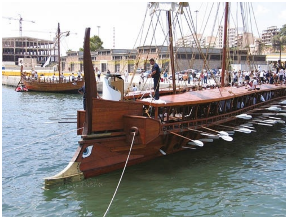
Reproducción a escala real de un trireme griego, el Olimpias , en el que se aprecia su espolón de proa, la cámara de boga y la cubierta en tingladillo. Estos buques de guerra no estaban hechos para aguantarse en la mar, se varaban sobre las playas e invernanan desmontados en grandes gradas cuando no se utilizaban.
